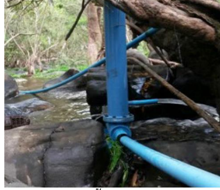
ภาพที่ 7 ตะบันน้ำขนาดใหญ่ (ซูเปอร์ตะบันน้ำ) ที่ตำบลหลักด่าน อำเภอน้ำหนาว จังหวัดเพชรบูรณ์
