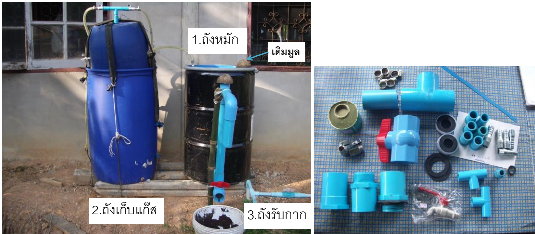
รูปที่ 3 ส่วนประกอบของการผลิตแก๊สชีวภาพแบบถังขนาด 200 ลิตร และวัสดุอุปกรณ์
