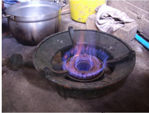
รูปที่ 2 เตาแก๊สแบบหัวฟู และเปลวไฟสีน้ำเงินของแก๊สชีวภาพ (แก๊สมีเทน)
